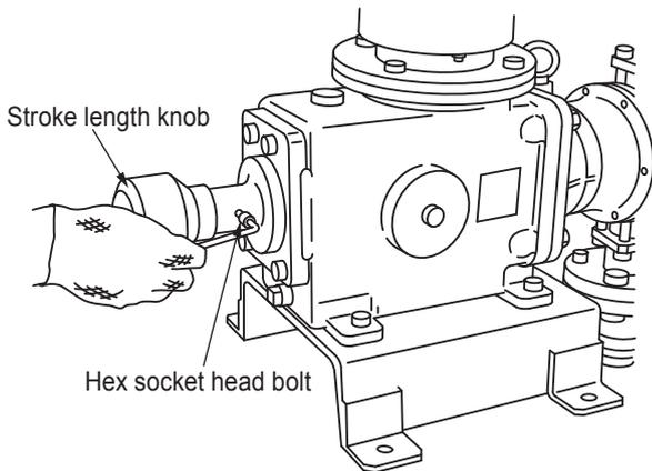
1. Loosen the hex socket head bolt.
